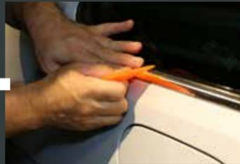
メッキモールの形状に合わせて切り出したダイヤモンドスウェルの形状に合わせて切り出したダイヤモンドスウェルを慎重に貼ってゆく。
