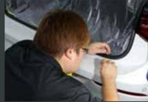
荷物の積み降ろしなどによりどうしても細かい傷が付きやすい部分。リヤバンパー上部全体に施工する。
